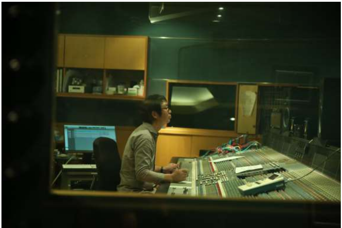
調整室での一コマ エンジニア高田さん「音が耳から全身の血液へ流れて行っているようです」 ダイナミクスを上手にコントロールできるかがダイレクトカッティングレコード制作の肝。コ ンプレッサーなどの調整を入念に行います。
