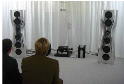
(写真 14) KEF が特別試聴室を構え発表した Muon。超弩級のデザインコンセプト・スピーカーだ。Muon とはクオークよりさらに小さな素粒子のこと。また Mu はムー大陸や日本の禅における「無」を意味しているという。ロス・ラブグローベによる美しいホルム。その磨き上げられたアルミの巨大なモニュメントはまさにムー大陸へのオマージュのようにも思える。4 ウエイ、計 8 個のユニットにより 20Hz から 100kHz をカバーする。最大出力は 118dB とこれも超弩級。
